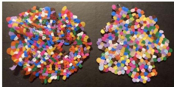
13. irudia. Erraminta de eskua. Materiala: PET plastikoa pellets formatutik termo-formatuta.
