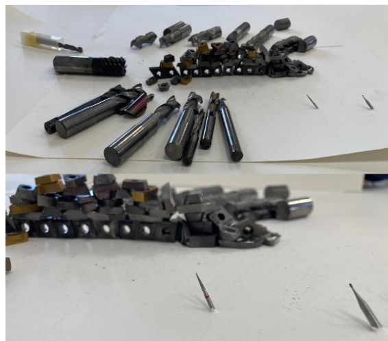
18. irudia. Wolfram karburozko erraminten konfigurazioa.
